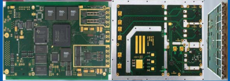
Digital- und Hochfrequenzelektronik des UWB Systems inklusive Multiport HF-Switch
