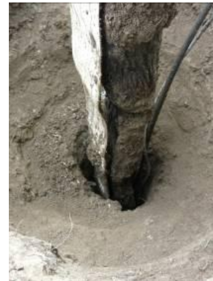
Eingebrachter 3 m langer Kabelsensor
